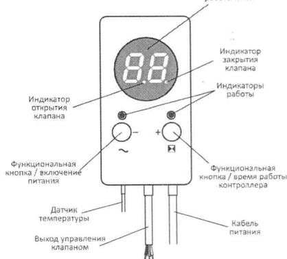
Индикаторы открытия и закрытия клапана используются для иллюстрации работы привода. Мигающие индикаторы указывают на работу клапана влево или вправо.
